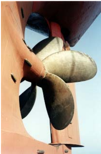
( De bladen van de scheepsschroef waren van de beschadigingen ontdaan.)
